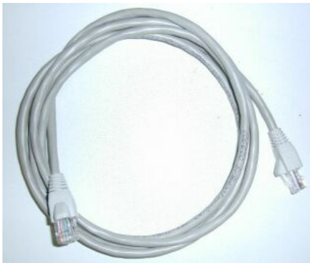
Nella foto un cavetto ISDN in uso per connessioni test di riferimento, UTP Categoria 5.
